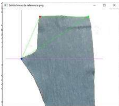
Figura 3 detección de esquinas con el algoritmo de Harris (fuente Propia 2020)
