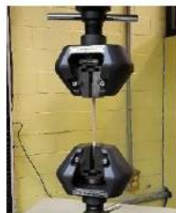
Figura 7. Imagen representativa de la prueba de tensión.
