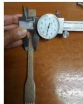
Figura 3. Medición de probetas.
