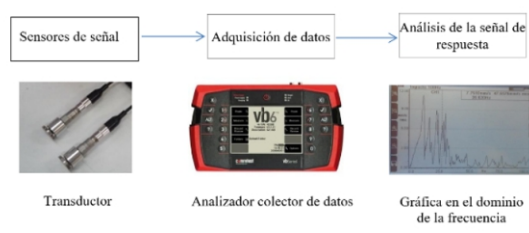
Figura 5. Proceso de adquisición de datos experimentales.
