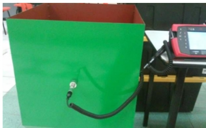
Figura 8. Montaje de un acelerómetro para realizar la prueba experimental.
