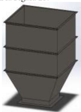
Figura 23. Modelo con tres elementos de rigidez (O3).
